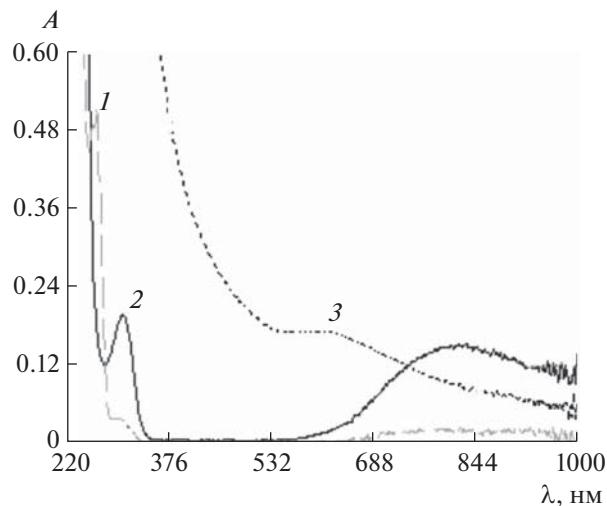
Рис. 2. Зависимость оптической плотности ( $A$ ) от длины волны ( $\lambda$ ) олигомера (лиганды) с медью в водной среде: 1 — олигомер на основе морфолина с эпихлоргидрином, 2 — нитрат меди, 3 — смесь олигомера с нитратом меди(II) [23].
