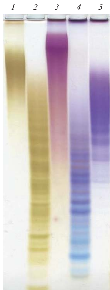
Рис. 8. Электрофорез в 20%-ном ПААГ образцов гепарина (1), эноксапарина (2), FCS-Hf (3), Hf-Fuc1 (4) и Hf-Fuc2 (5).
