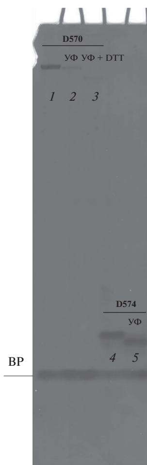
Рис. 8. Электрофореграмма олигонуклеотидов: D570 (“звездочка” РОСТ-2, рис. 5д) до (дорожка 1) и после (дорожка 2) облучения УФ-светом ( \lambda = 365 нм) и после обработки ДТТ (дорожка 3); D574 до (дорожка 4) и после (дорожка 5) облучения УФ-светом ( \lambda = 365 нм). Условия: 15%-ный ПААГ, 8 М мочевины, 1× ТВЕ, рН 8,3, окрашено красителем Stains-All. ВР – краситель бромфеноловый синий.
